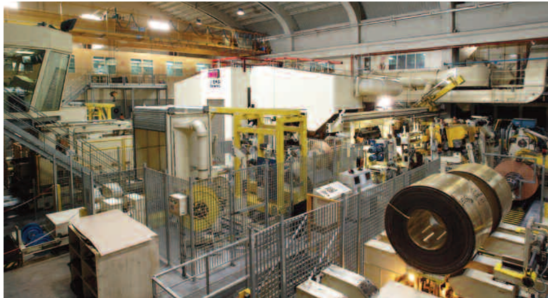
L'impianto di laminazione a freddo Sesto, in grado di laminare 1.000 metri al minuto
